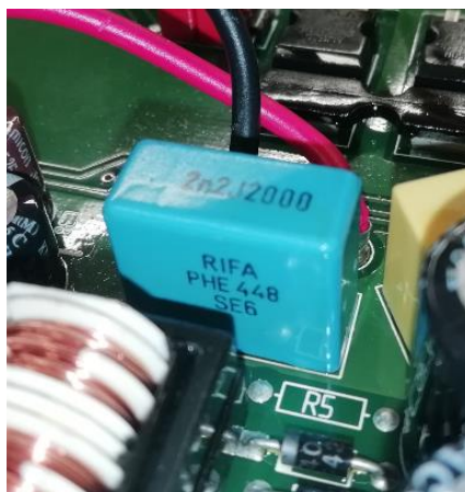
Obrázek IV: Fotografie rezonančního kondenzátoru na primární straně
