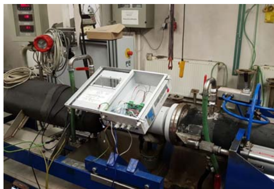
Testování průtokoměru WFMU01 na vodní trati zkušebny kapalinových průtokoměrů společnosti ELIS Plzeň
