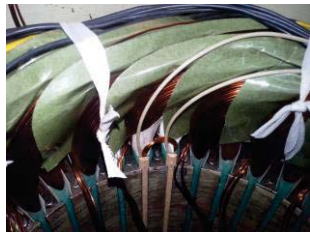
Obrázek 2 Měřicí cívka navinutá na satorového zubu
