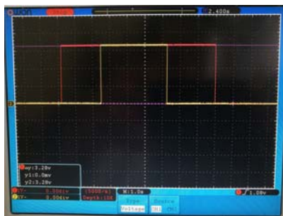
Obrázek 2 – Vstupní charakteristika binárního vstupu
