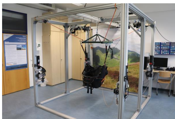
Celkový pohled na simulátor osazený pěti pohony
