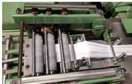
Průtažné ústrojí protahovacího stroje Rieter RSB 851 – mísení PESH přízi a ocelových střížových vláken.
