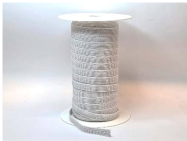
Realizovaný prototyp pružné vodivé stuhy ve čtyřvodičovém provedení.
