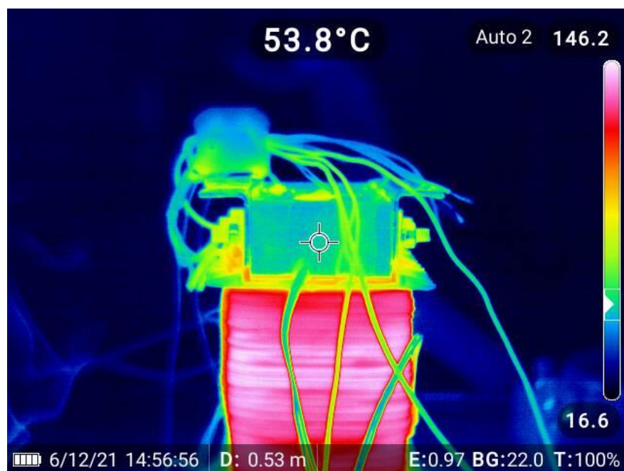
Obr. 6: Snímky z termokamery při měření ochlazovací charakteristiky - 2
