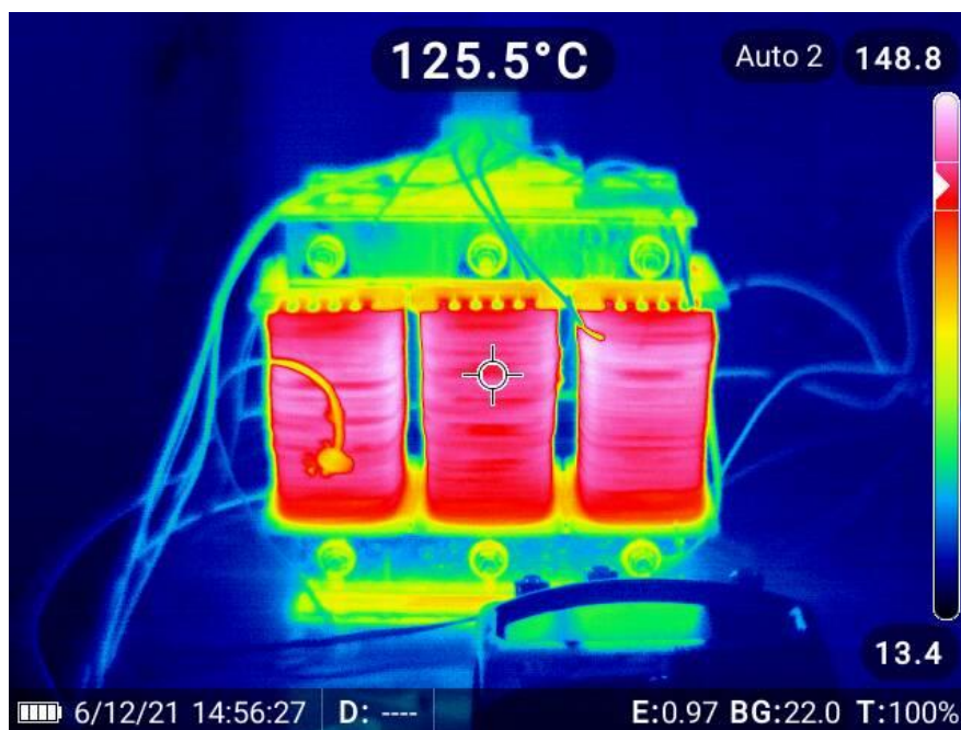
Obr. 5: Snímky z termokamery při měření ochlazovací charakteristiky - 1
