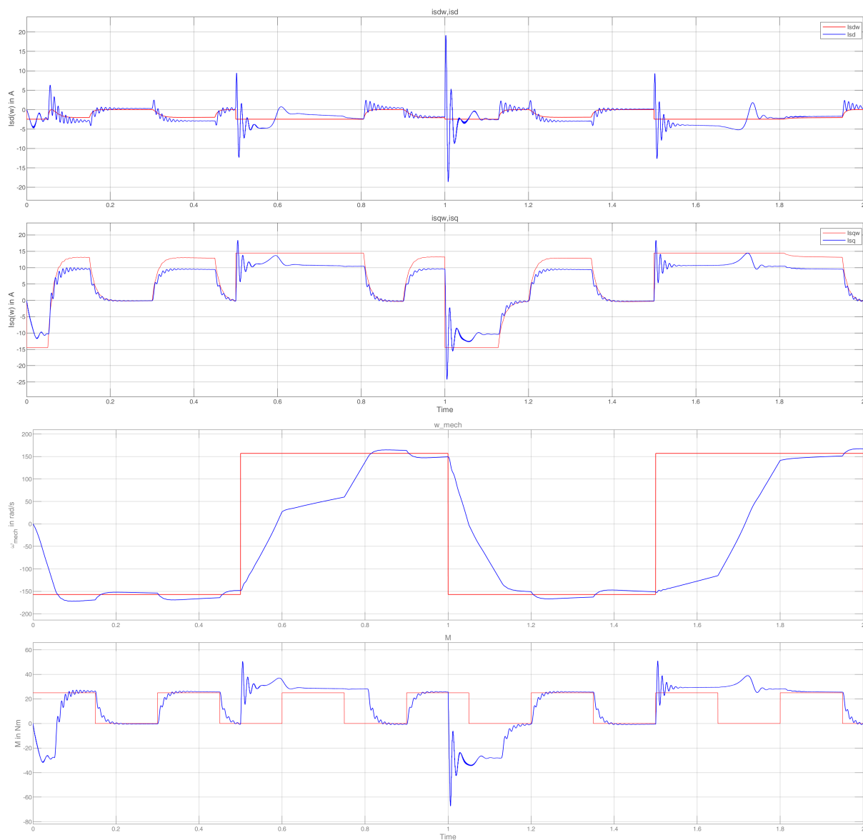
Obr. 3.4: PI regulace proudů stroje - Průběh požadovaných a skutečných proudů (nahore), otáček a momentu stroje (dole) v souřadném systému dq s uvažováním dopravního zpoždění PWM
