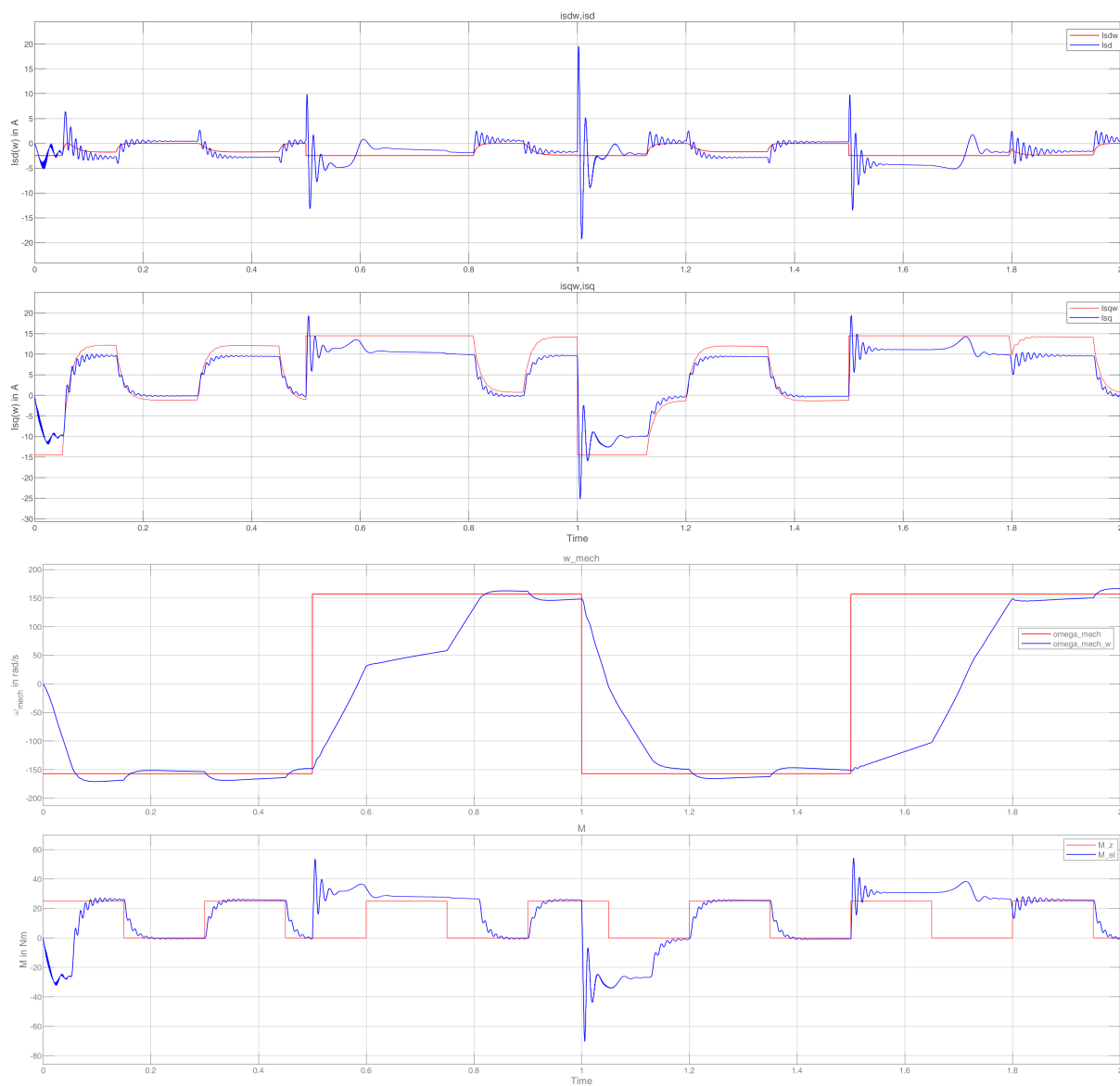
Obr. 3.2: PI regulace proudů stroje - Průběh požadovaných a skutečných proudů (nahore), otáček a momentu stroje (dole) v souřadném systému dq
