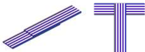
Obr. 1: Model kontaktní struktury – vodivé spojení dvou stuh a vytvoření odbočovací struktury pomocí vodivých stuh.
