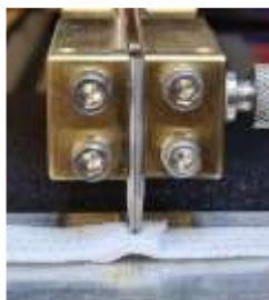
Obr. 2: Proces odporového bodového svařování metodou TCB.
