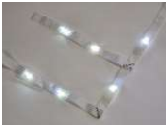
Obr. 4: Odporově svařená stromová sběrníková struktura pro smart textilní aplikace.
