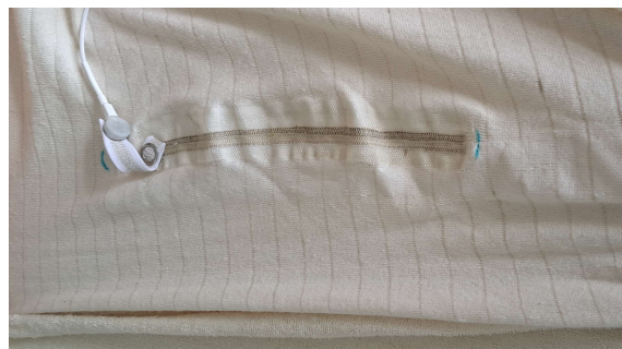
Obr. 2: Detail ultrazvukové přivařené sběrné elektrody na vyhřívací textilií.
