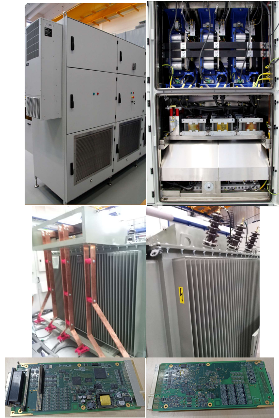
Obr. 1 Optimalizovaný prototyp zařízení pro kompenzaci zemních poruch včetně optimalizovaného transformátoru 22/0,4 kV a řídicího systému
