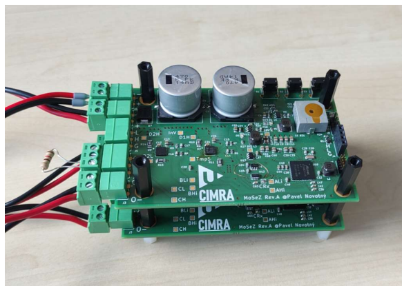
Dvě elektronické jednotky modulu proudového zdroje pracující simultánně.
