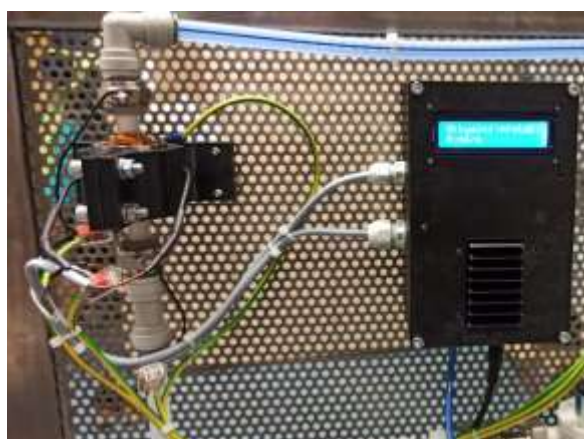
Elektromagnetické buzení se snímacími elektrodami (vlevo), řídicí jednotka s datovým a napájecím vstupem (vpravo)
