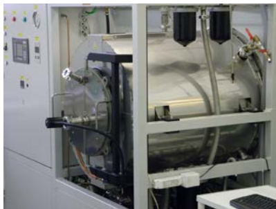
Vakuové Pec Clasic pro výpal miedných past na AlN v inertní atmosféře.
