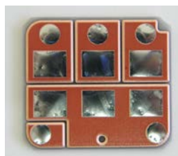
Ukázka pájitelnosti Cu vrstvy na AlN substrátu
