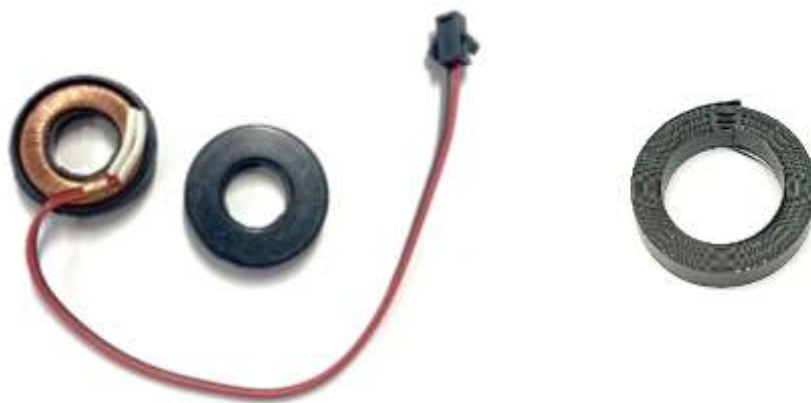
Obrázek 12: Vnitřní uspořádání proudového transformátoru 100 A - 1000:1. Vlevo odstraněný kryt, vpravo samotné jádro z permalloy.
