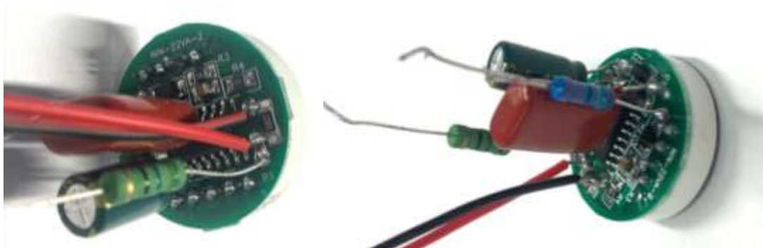
Obrázek 11: Vnitřní zapojení elektroniky AD101-22VAM.
