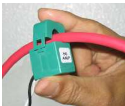
Obrázek 7: Proudový transformátor Magnelab SCT-0400-025 [5].
