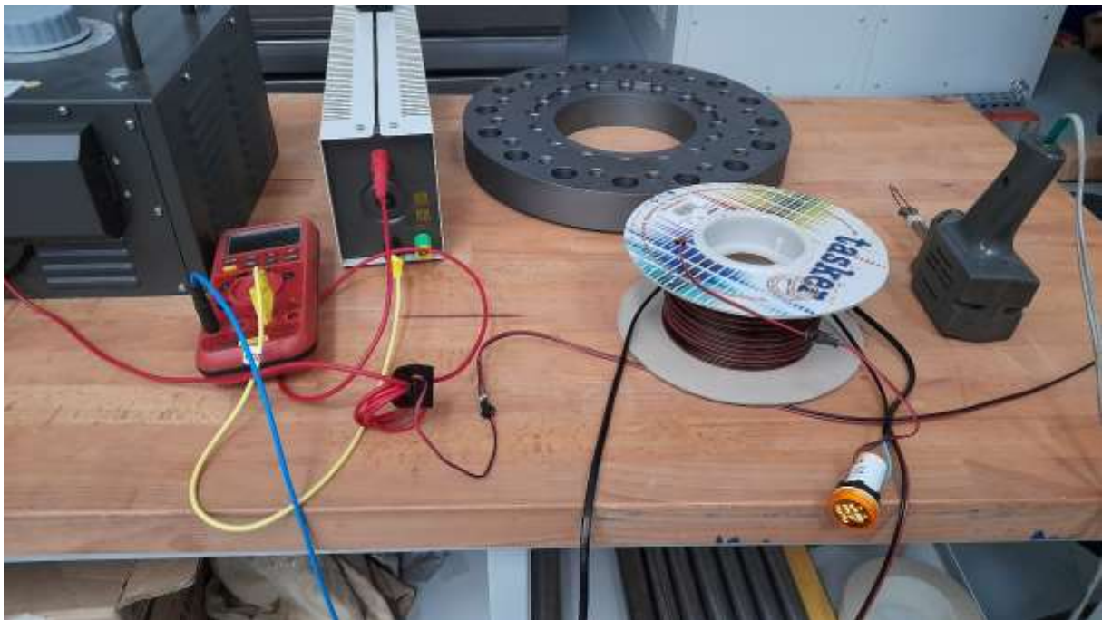
Obrázek 14: Testování AD101-22VAM s prodlouženým vedením snímače proudu (prodloužení bylo cca 30 m a procházelo kolem výkonového měniče).
