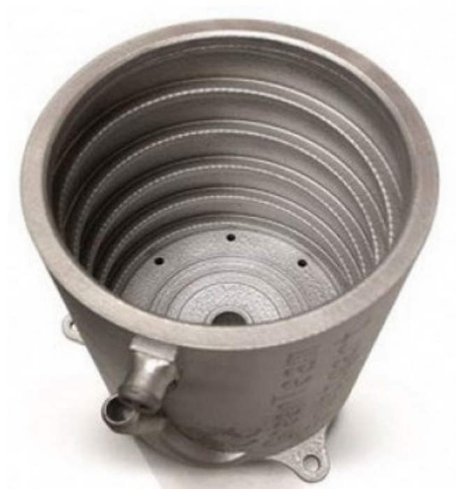
Obrázek 33: Tištěná kostra motoru elektromobilu [20]
