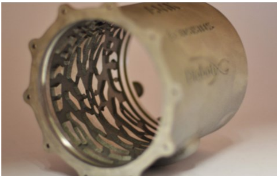
Obrázek 32: Optimalizovaný chladič aplikovaný v kostře elektrického stroje[19]
