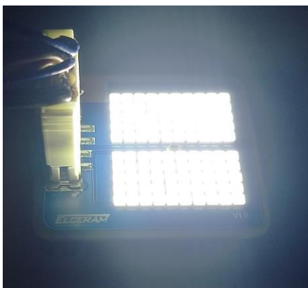
LED zdroj na substrátu AlN – ukázka funkce.
