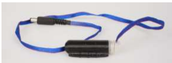
Obr. 1: Realizace pratelného zpětnovazebního prvku včetně zapouzdření a nakontaktování na textilní stuhu s integrovanými izolovanými hybridními nitěmi.
