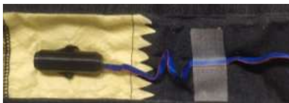
Obr. 2: Integrace pratelného zpětnovazebního prvku do 3-vrstvého hasičského obleku v oblasti límce.
