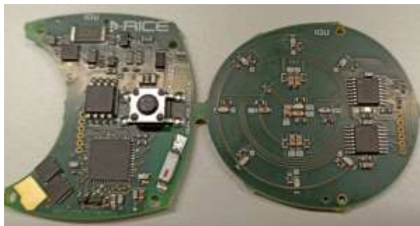
Obr. 2: Vyrobená sestava desek plošných spojů pro rukavici s navigačním systémem a s integrovaným světelným kompasem.
