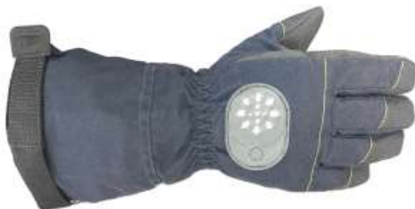
Obr. 3: Realizovaná rukavice s navigačním systémem a s integrovaným světelným kompasem pro lokalizaci ohrožené osoby.
