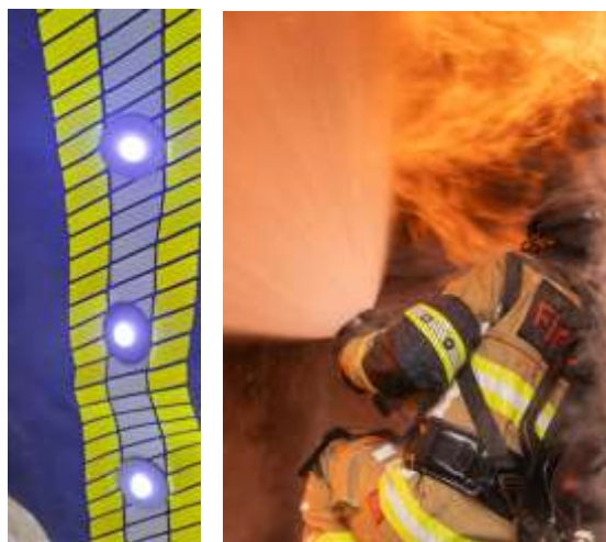
Obr. 4: Integrace LED osvětlení pomocí nově vyvinuté technologie pouzdrění do hasičských obleků během testování v hasičském ohňovém polygonu.
