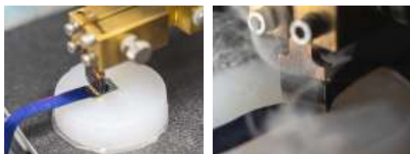
Obr. 2: Elektrické a mechanické připojení DPS konektoru na vodivou stuhu pomocí odporového.
