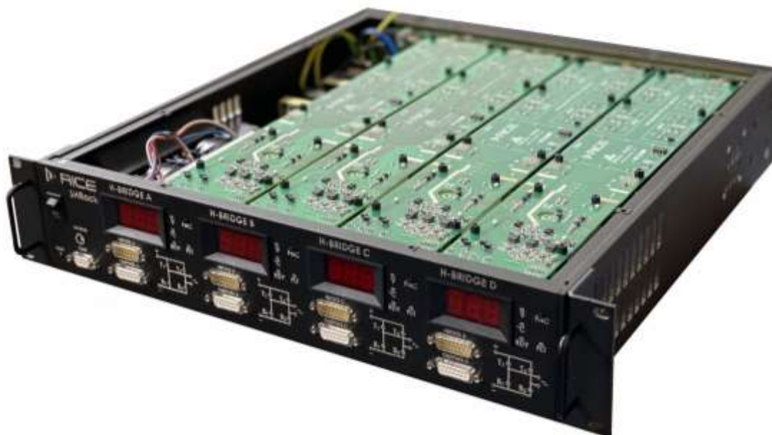
Obr. 7.2 Univerzální modulární měnič SHRack
