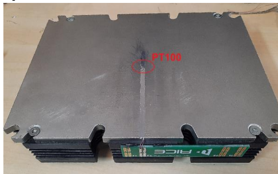
Obr. 2 Umístění chladiče v měřícím rámu. a) Pořadí modulů na chladiči M1 – M4, b) Integrace snímače teploty PT100 do základny modulu.
