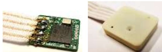
Obr. 2: Senzor hluku systému Multitex.
