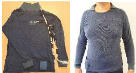
Obr. 2: Realizované funkční triko s integrovaným elektronickým systémem.
