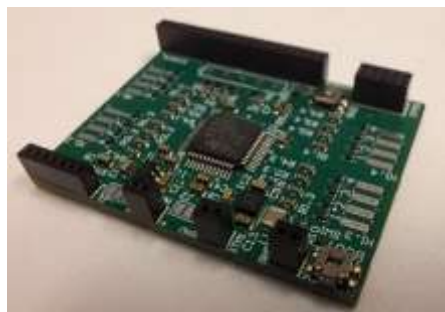
Obr. 2: Vyhodnocovací elektronický modul pro detekční textilii.
