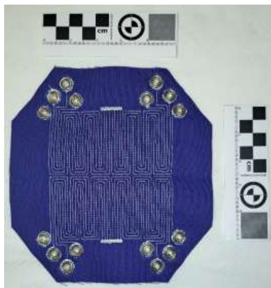
Obr. 1: Senzorový element detekční textilie pro detekci a lokalizaci penetrace.
