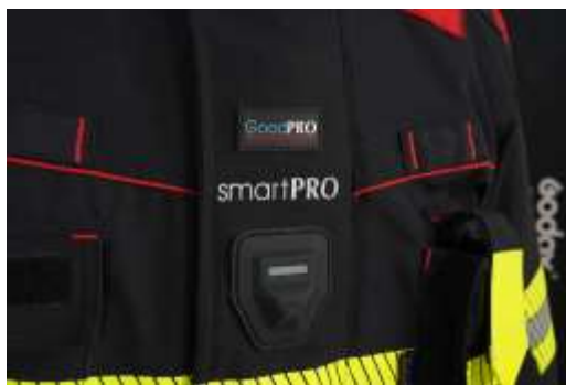
Obr.2: Ovládací modul chytrého hasičského obleku.
