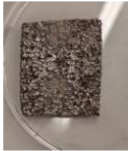
Obr. 1: Katalytická membrána s nanesenými plazmonaktivními strukturami.
