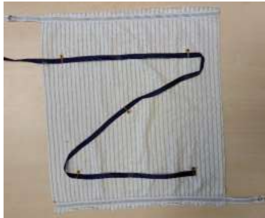
Obr. 1: Vyhřívaná textilie s implementovanými teplotními senzory.
