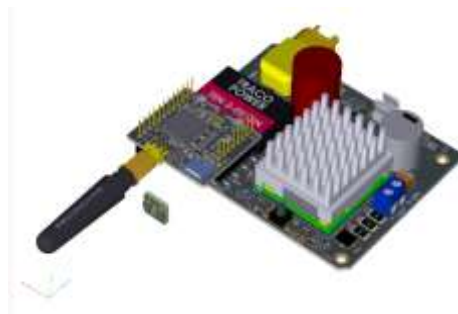
Obr. 3: Řídicí elektronický systém pro plošné vyhřívání pleteniny.
