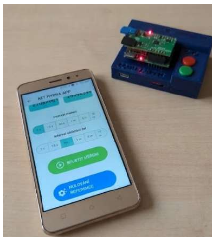
Obr. 3: Funkční vzorek komunikačního a vyhodnocovacího elektronického systému pro healthcare senzory s přenosem naměřených dat do vytvořené aplikace v mobilním telefonu.
