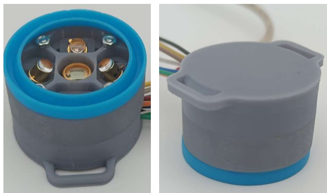
Obr. 3: Funkční vzorek sensorového systému pro měření hydratace pokožky pomocí infračervené spektrofotometrie s NIR diodami s vlnovou délkou 960 nm, 1200 nm a 1450 nm..
