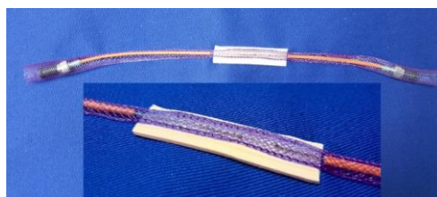
Obr. 3: Integrace senzorevého vlákna na textilní substrát.
