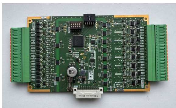
I/O karta umožňující 16 vstupů a 16 výstupů
